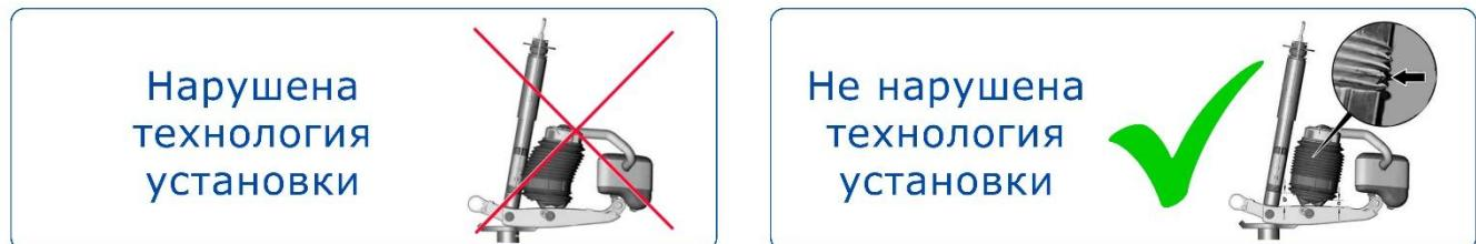
Для правильной установки заднего пневмобаллона Mercedes E-class w211, Mercedes CLS-class w219 используйте специализированный инструмент под номером E4-XK0-Z024A00.
